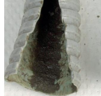
**Biofilm im Absaugschlauch**
