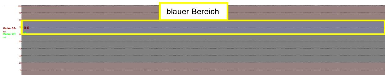
Der Ventilstrom soll im blau eingefärbten Bereich (zwischen 60mA und 80mA) liegen. Sollte der Ventilstrom dauerhaft über dem blauen Bereich liegen (>80mA) ist das Ventil zu tauschen. Mit einem weiteren Klick auf „On“ wird das Ventil wieder stromlos gemacht.
