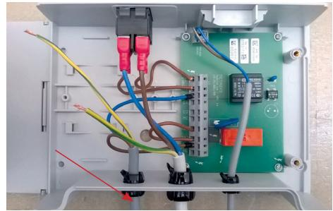
4 Raccorder le câble du moteur (câble bleu sur MN, câble marron sur ML)
